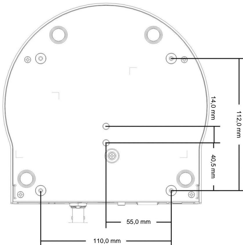
2. Diagramme des dimensions de la plaque métallique
