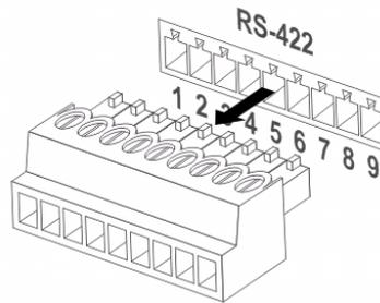
2. Décollez une section de fil de cuivre (Nos AWG 28 à 18) et l'insérer dans le trou du connecteur, puis utiliser un tournevis plat pour le fixer
