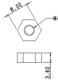
Écrou de verrouillage plaque métallique B
