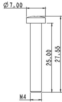
Vis de verrouillage de plaque métallique B
