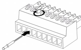
3. Réinsérez le connecteur câblé RS-422 dans la Caméra. Maintenant la connexion est complétée
