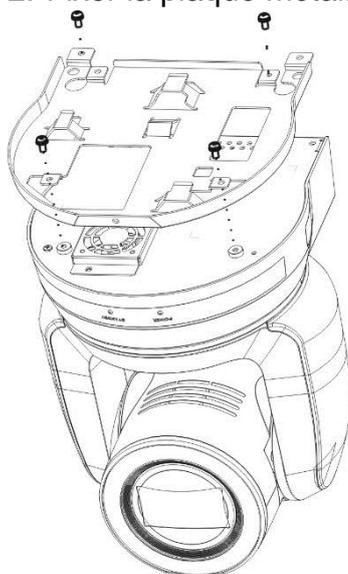
3. Verrouiller la plaque métallique B sur le support de montage de plafond.
