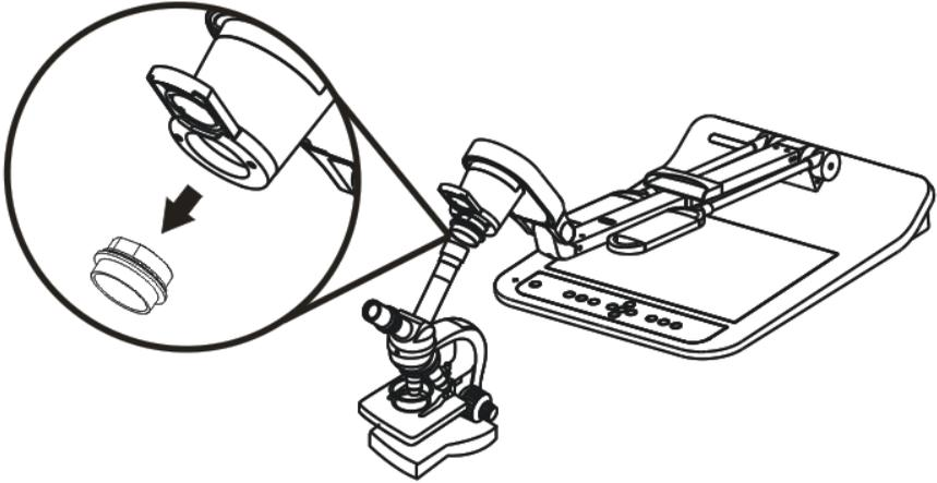
Falls das Okular  $\varnothing$  28 mm oder  $\varnothing$  31 mm ist, benötigen Sie **zwei Mikroskopadapter**. (1. Der **Lumens Mikroskopadapter**. 2. Der **Mikroskopadapter** passend für Okulargröße  $\varnothing$  28 mm oder  $\varnothing$  31 mm.)
