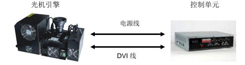
Case 2: 连接 CU106/CU106W ,使用配件 DVI 线材将控制盒输出端口连接机芯 DVI 端口 使用 DVI 长线 (控制单元的配件)
