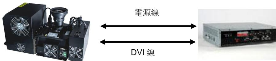
Case 2：連接 CU106/CU106W，使用配件 DVI 線材將控制盒輸出端口連接機芯 DVI 端口
