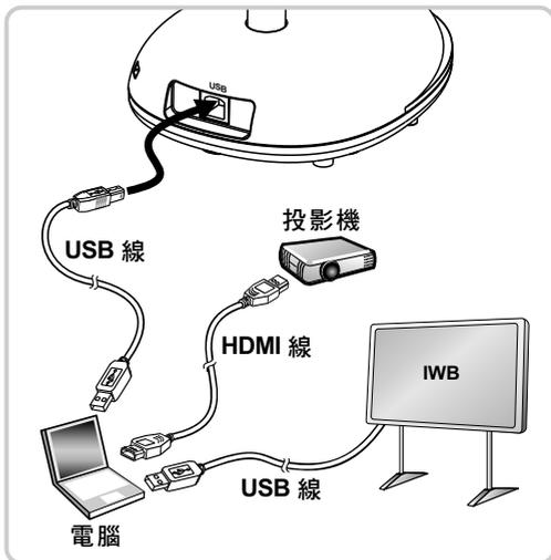
⚠ 當USB連接上電腦，電源即啟動。LED顯示燈亮紅燈，表示顯示影像中。
